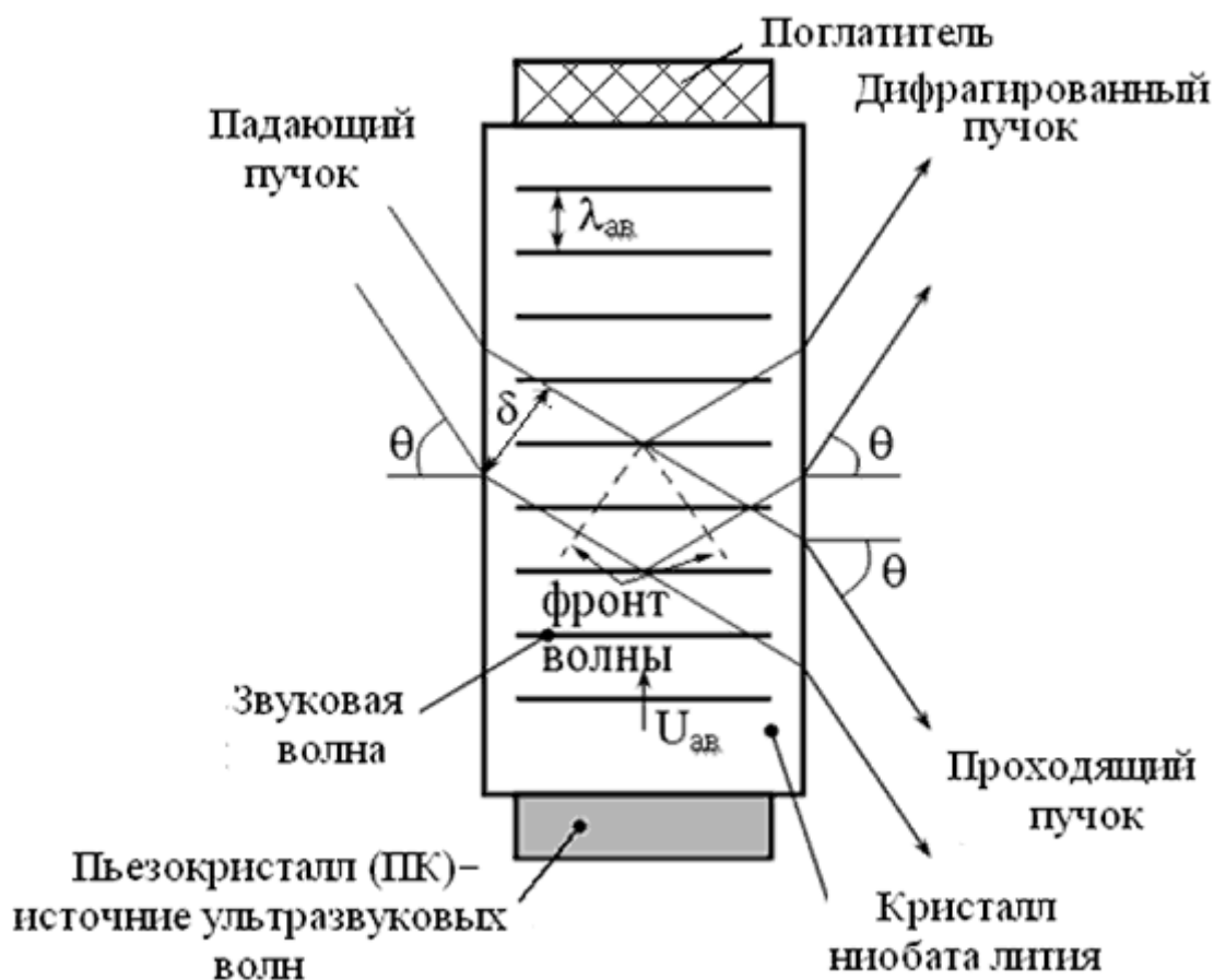
Рисунок 4.1.1 – Схема прохождения пучка света в АОМ
