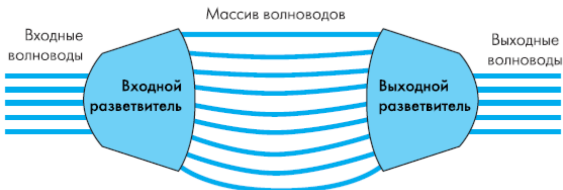
Рис. 2.2.1 Схема мультиплексора с входным и выходным разветвителями.
